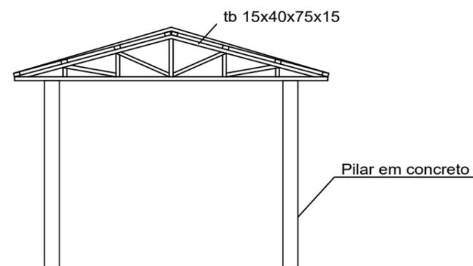
Detalhe metálica Esc.: S/E
